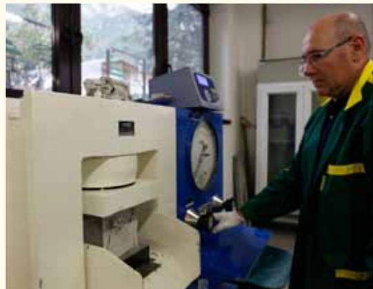
FOTO Controllo di qualità del calcestruzzo presso il Cantiere centrale
